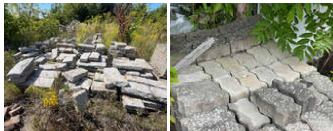
Fotos: li. Granitborde | re. Verbundsteinpflaster
